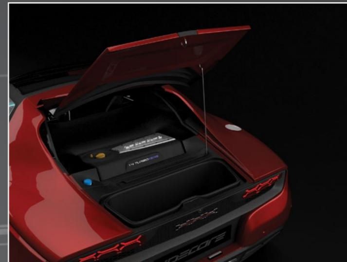
xxx è interamente strutturata attorno alla stessa vasca in carbonio che ha dato origine l'Alfa Romeo 4C di cui mantiene passo, carreggiata e disposizione meccanica. Differiscono invece gli sbalzi e la motorizzazione. La xxx è equipaggiata con un propulsore 1,4 turbo Multiair dotato di dispositivo Kers.
